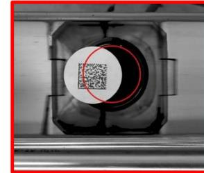
Основной режим работы – автоматический. Продукция перемещается по конвейеру. При прохождении зоны контроля смарт-камера производит инспекцию. Если результат инспекции не соответствует заранее заданным критериям, на выталкиватель поступает сигнал и единица продукции механически сдвигается с конвейерной линии. Отбраковка производится на параллельный конвейер или контейнер для брака. При критическом количестве ошибок конвейер останавливается.
